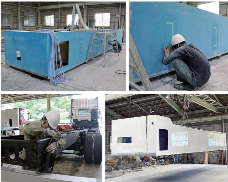
軽くて強く耐腐食性に優れるFRP(繊維強化プラスチック)で作られた水槽の耐用年数は約25年であるのに対し、トラックの車体は約5年。活魚運搬車は海水を扱うため塩害による腐食を受けやすく、車体が古くなると載せていた水槽部分を取り外して新しい車体に載せ替える業務も行っており、新車の製造と水槽載せ替え業務はおおよそ半々の割合です。
