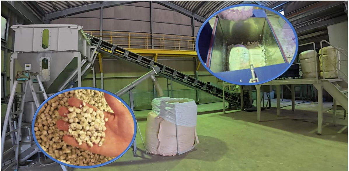
図 6 使用済み発泡スチロール製フロートの減容リサイクル技術と減容ペレット化
